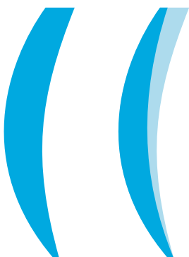
Obr. 23: Ztenčování prizma u progresivní čočky.
